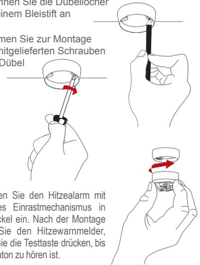
2. Setzen Sie den Hitzealarm mit Hilfe des Einrastmechanismus in den Sockel ein. Nach der Montage testen Sie den Hitzealarm, indem Sie die Testtaste drücken, bis ein Warnton zu hören ist.
